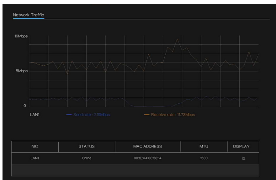
図 92 ネットワークトラフィックインターフェース
