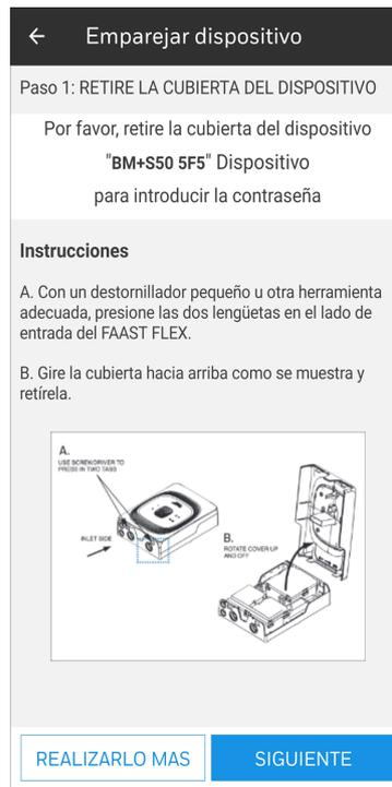
2. Abra la cubierta del detector.
