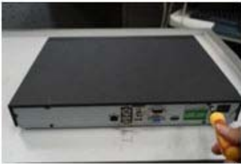
図 15-7NVR カバーの固定
