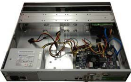
図 15-11HDD と電源ケーブルの接続
